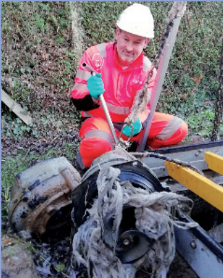
Exemple d'une pompe obstruée par les lingettes sur le territoire de l'Eure
